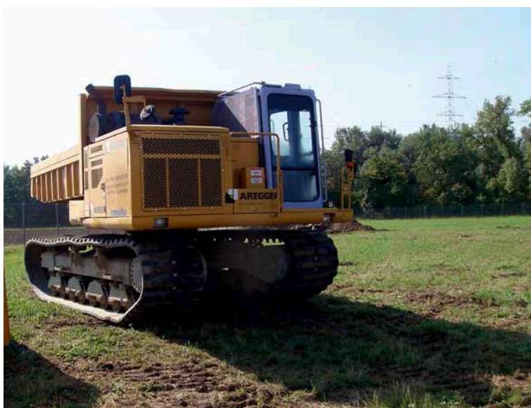
Véhicule de chantier ménageant le terrain
