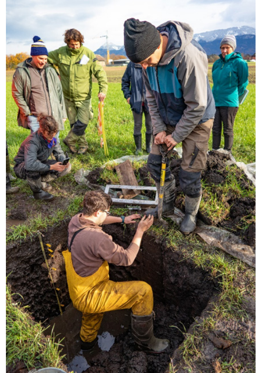
Entnahme eines Minikastenprofils
