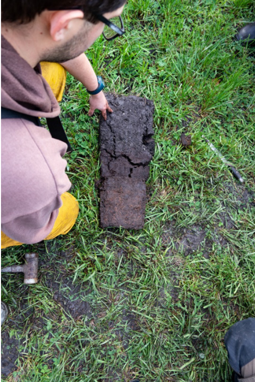
Laurentiu Constantin zeigt vor, wie man mithilfe eines «Kastenprofils» oder einer Spatenprobe die sekundäre Gefügebildung in Moorböden beschreibt.
